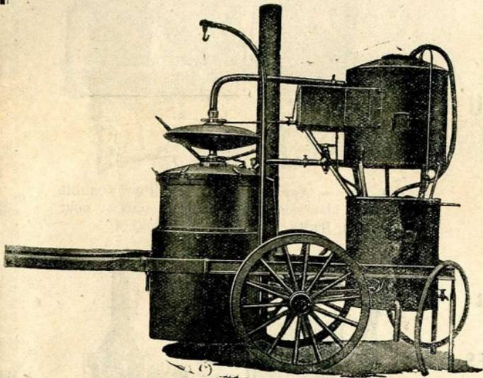
Alambic sur chariot fer avec chauffe vin
